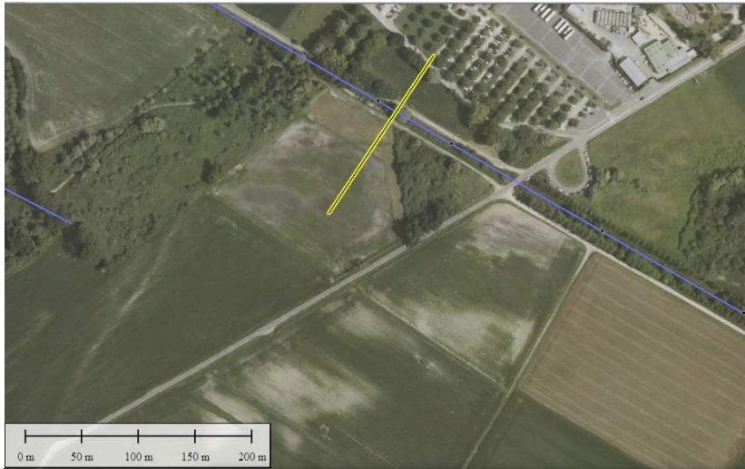
Illustration 33 : Vue aérienne du canal du Champ (en bleu) et profil topographique (en jaune) au niveau du barrage de castor.
